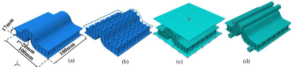
Fig. 14 Dome shaped honeycomb (a) Geometry (b) Core (c) Compression (d) Flexural
